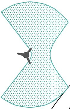
Schattenwurf einer Windkraftanlage über ein Jahr
